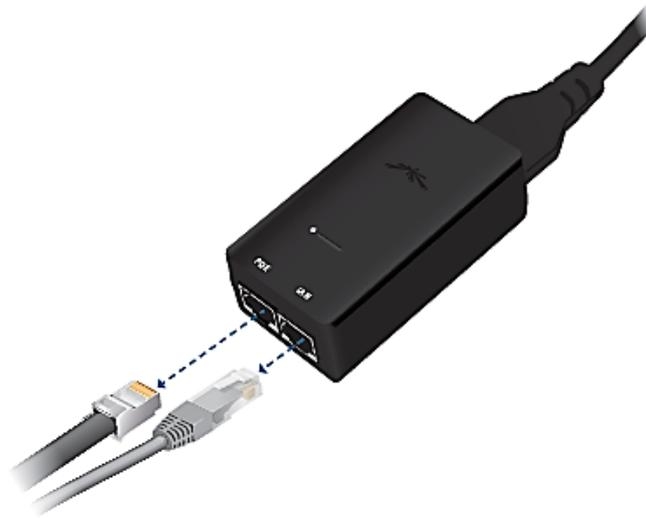
2. *Stecken Sie nun den RJ45 Anschluss des air gateways (siehe Bild unten) in den Ethernet Anschluss „PoE“ am Poe Adapter und drücken Sie die beiden Geräte jetzt so zusammen, dass sie ineinander einrasten.*
